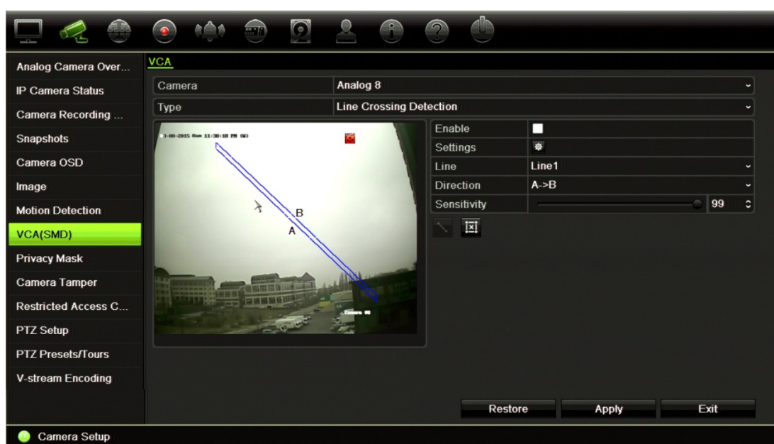
Figura 21: Ventana de detección de línea cruzada
